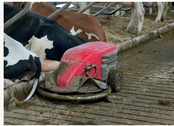
Der **Spaltenroboter** säubert den Boden damit es trocken und sauber ist.
